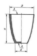
Тигли изготовлены из фарфора. Покрыты глазурью за исключением верхней кромки и внешней стороны дна. Стойкость глазури к воздействию температуры не менее 900 °C. Устойчивость к термоудару – 230 °C.
