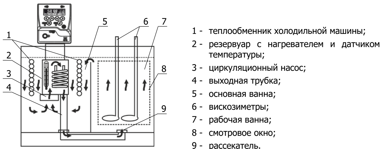
Рисунок 2 — Устройство термостата
